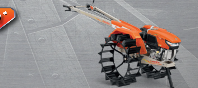
NC Plus X Special ล้อขนาด 980 มม. รุ่นล้อใหญ่พิเศษ ในล้อใหญ่ ขนาด 5 นิ้ว จำนวน 16 ใบ รุ่นล้อใหญ่พิเศษทั้ง 2 ขนาด ช่วยเสริมการจิกดินระหว่างการไถ ลดการสิ้นเปลือง เหมาะสำหรับการไถเตรียมดิน ในสภาพดินหล่ม-หล่มมาก
